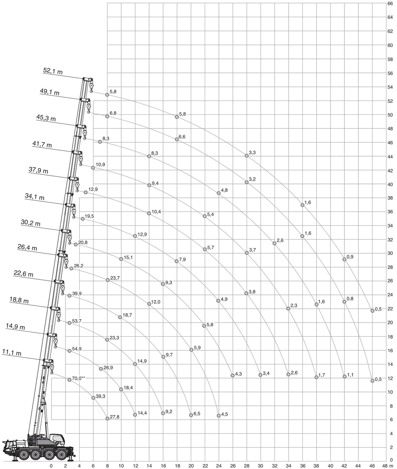
\*\* Max. crane capacity – with additional special equipment · Max. Tragfähigkeit – mit zusätzlicher Sonderausstattung · Capacité maximale de la grue (avec équipements spéciaux additionnels) · Max. capacità della gru – con equipaggiamento speciale aggiuntivo · Capacidad máx. de grúa – con equipamiento especial adicional · Capacidade máx. da grua – com equipamento especial adicional · Макс. грузоподъемность крана – с установленным дополнительным оборудованием
